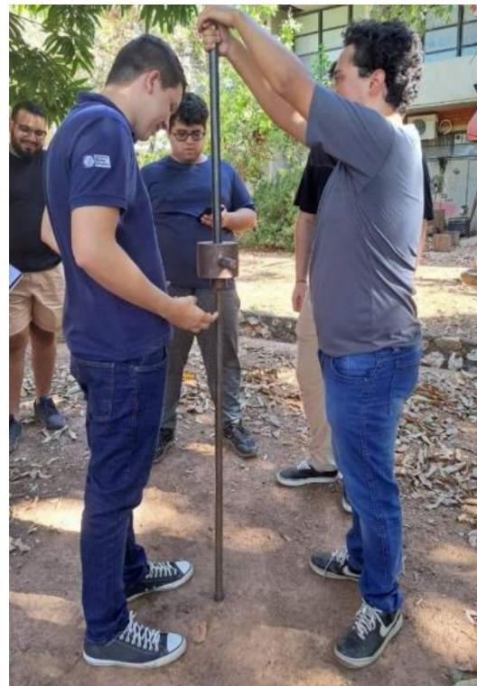
Figura 3: Equipamento Penetrômetro Dinâmico Leve utilizado nesta pesquisa. Fonte: Autores.
