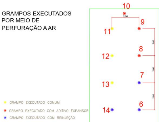
Figura 2. Layout dos grampos executados por meio de perfuração à ar, com legenda
