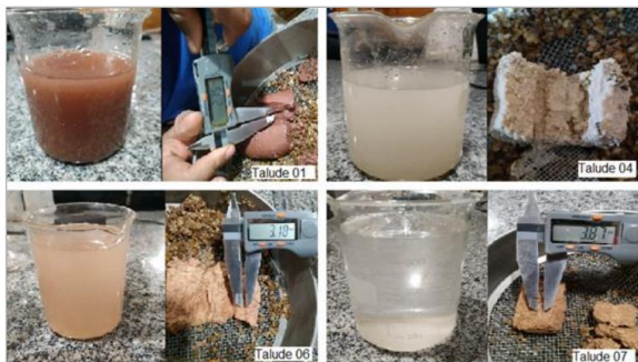
Figura 10. Coloração do fluido após ensaio e conferência do diâmetro final das amostras.
