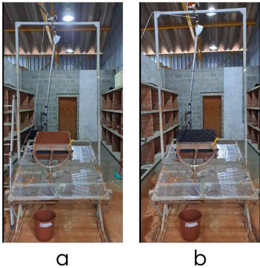
Figura 1. Ensaio simulado de chuva. a) solo exposto b) solo recoberto com geossintético. Fonte: Autor (2023).
