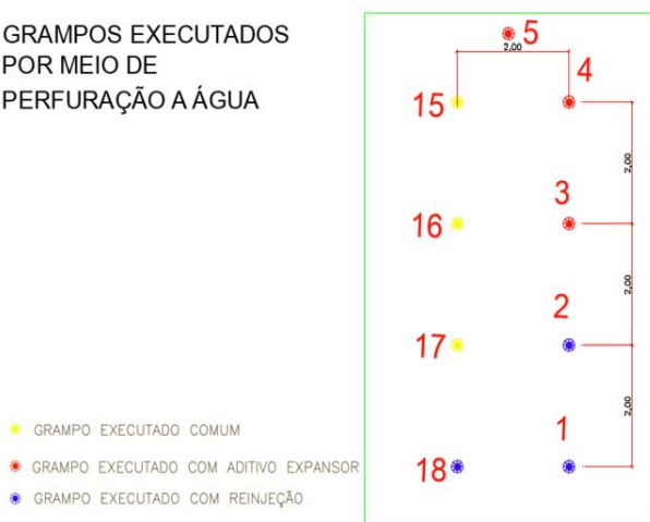
Figura 1. Layout dos grampos executados por meio de perfuração à água, com legenda
