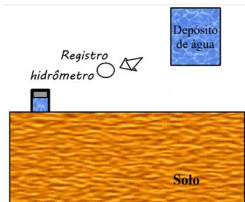
Figura 6. Ensaio de permeabilidade em furo de sondagem.
