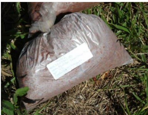
Figura 3. Armazenagem e identificação das amostras de solo. Fonte: Manual do sondador (2013).
