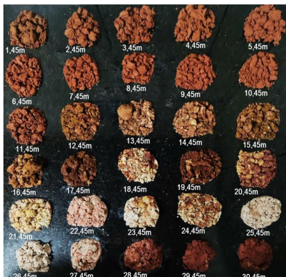
Figura 6 – Amostras de solo do furo SP 01 (Fonte: Relatório de sondagens: Guaracon engenharia)
