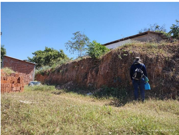
Figura 5: Corte de perfil de solo residual na margem direita do Córrego Baú. Fonte: Autores.
